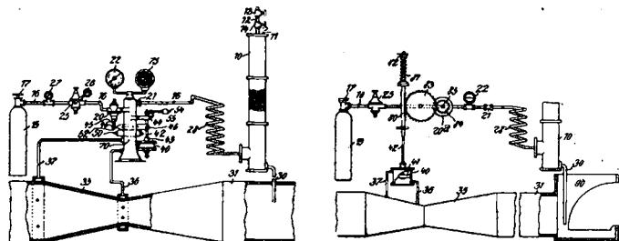
die den Zuführungsdruck des Gases entsprechend einem bestimmten Verhältnis der Menge des zuzuführenden Gases zur Durchflußmenge der zu behandelnden Flüssigkeit selbsttätig regelt. — 2. Vorrichtung nach 1, dad. gek., daß der Druckunterschied an zwei verschiedenen Punkten einer in die Flüssigkeitsleitung 31 eingeschalteten Venturirohre 35 oder dgl. durch Druckleitungen 36, 37 auf die beiden Seiten
