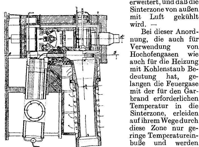
der Zeichnung angedeuteten, bedeutenden Erweiterung des Ofenquerschnitts, beim Eintritt in die Calcinerzone erheblich abgekühlt; durch Steigerung der Umlaufgeschwindigkeit des Ofens kann die Einwirkung der Feuergase auf das Brenngut und damit die Leistung des Ofens bedeutend gesteigert werden, ohne daß ein Mehr an Heizgasen erforderlich wird. (D. R. P. 288 727. Kl. 80c. Vom 15./4. 1913 ab. Ausgeg. 15./11. 1915. Zus. zu 256 394.) rf. [R. 4730.]
